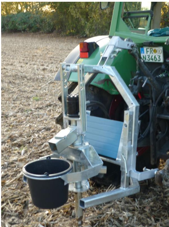
Bodenprobegerat Fur das Ziehen von Bodenproben fur die Grunduntersuchung, kann auch am Schmalpurschlepper angebaut werden, und
