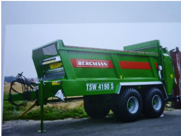
Miststreuer Bergmann 16 to Gesamtgewicht. Zugkraftbedarf ab 120 PS Stauschieber Mietpreis 28,00 €/ Std
